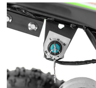
Switch för inställning av maxhastighet
