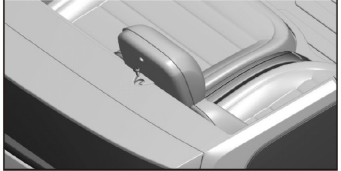
13. Aseta selkänojat istuimien yläpuolelle ja kiinnitä autoon niskauten takaa ruuvilla.
